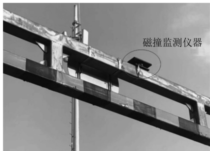
图 5 龙门防撞架的在线监测设备实景图
