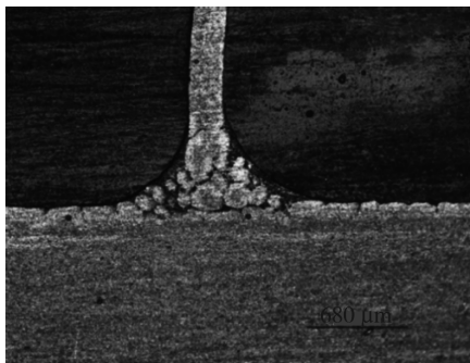
图8 钎焊接头的宏观金相图
