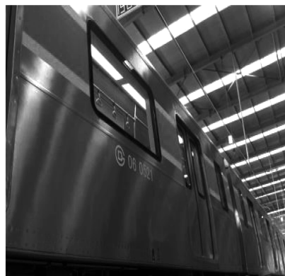
b) 激光焊侧墙实景
