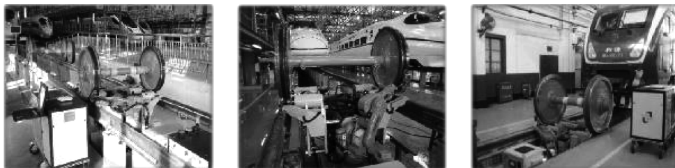
图7 移动式轮辋轮辐探伤系统布置图
