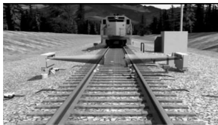
图3 轨边声学诊断系统布置图
