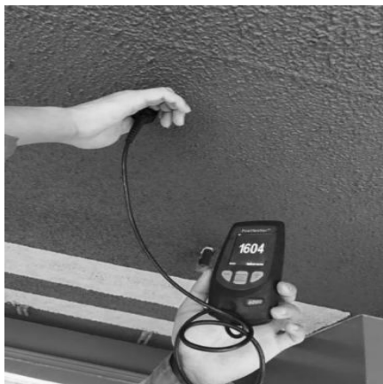
图2 防火涂料使用于铝合金车体底架下表面
