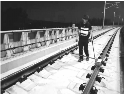
图 3 钢轨表面不平顺测量
