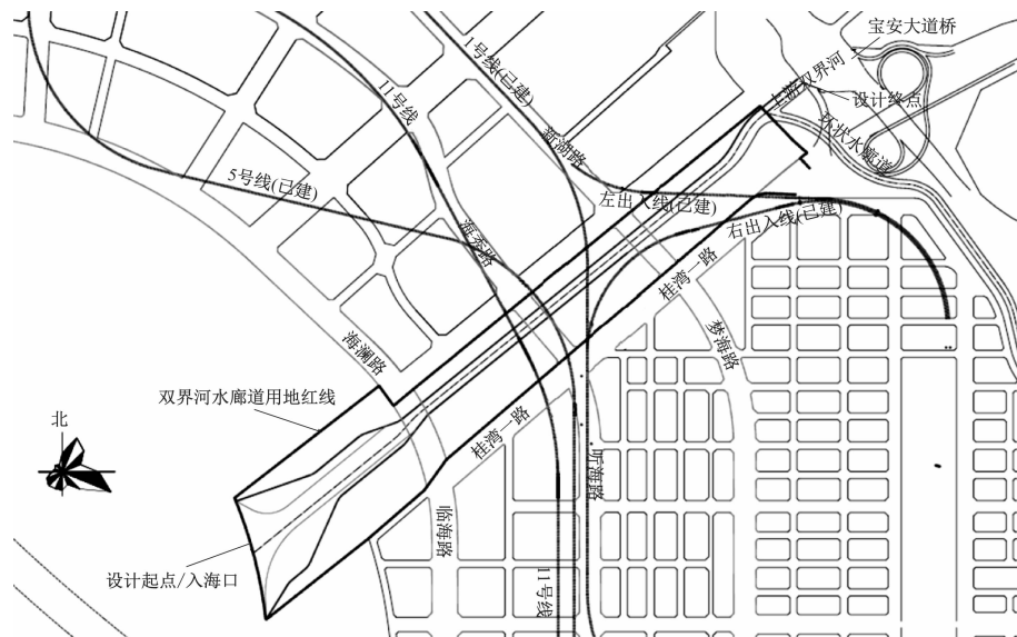
图1 双界河水廊道工程与地铁线路平面位置关系图
