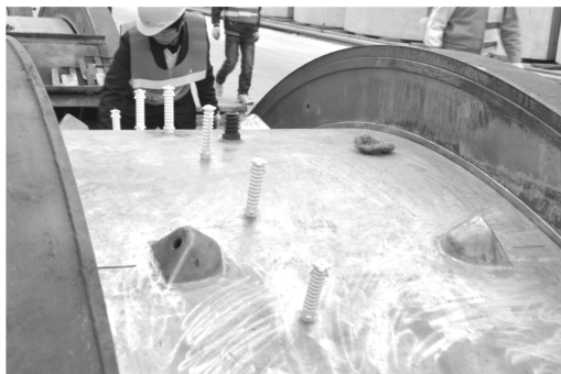
图 14 尼龙套管在管片上的安装
