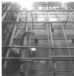
a) 在管片模板预埋了套筒 b) 管片模板上的套筒和钢筋笼
