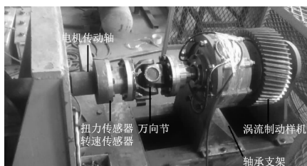
图10 永磁减速装置台式试验系统
