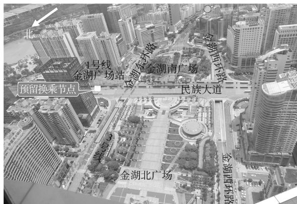
图1 南宁地铁1号线金湖广场站预留换乘节点称布置,其中北广场地下空间为两层,南广场为地下一层。3号线车站设置于北广场,但北广场地下空间东侧边线距规划道路红线仅6.0 m。同时,在金湖广场东北象限还有众多的26层以上高层商业写字楼,均设置了地下空间,地下空间结构边线距离金湖北广场地下空间结构边线最窄处仅35.8 m,车站站位需整体考虑与金湖北广场地下空间、高层写字楼及其地下室的关系(见图2)。
