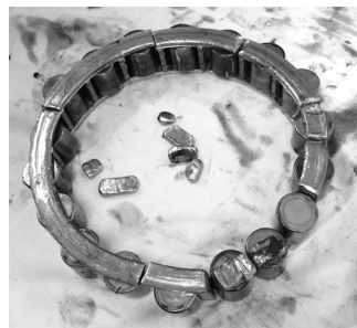
图 2 铜保持架断裂
