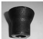
图 2 故障绝缘子受蚀的钢脚铁件
