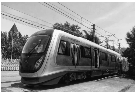
图 5 “下一代地铁列车”进行厂内动态调试
