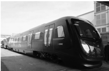
图 4 全新碳纤维地铁车辆“CETROVO”
