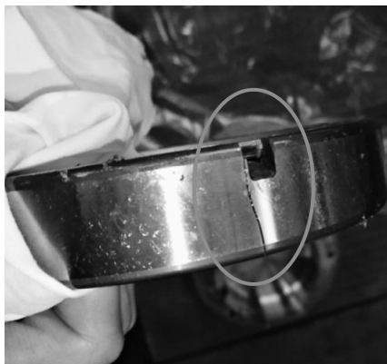
图1 轴承定位销处开裂
