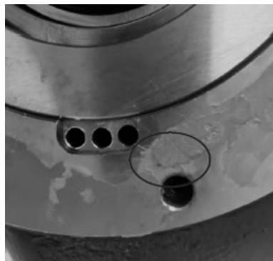
图7 端盖密封缺陷情况
