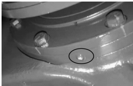
图5 齿轮箱电机侧渗油
