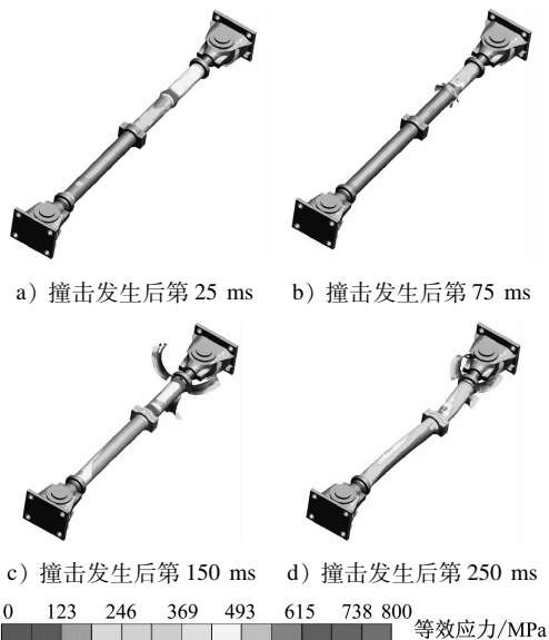
图5 撞击过程中钩缓装置压溃变形与等效力分布
