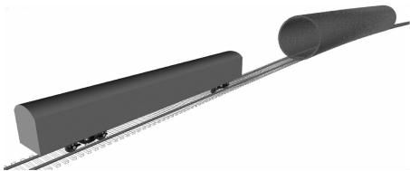
图1 车辆-轨道-隧道刚柔耦合模型
