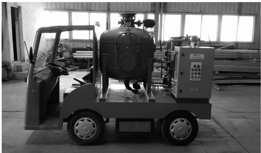
图 4 有轨电车车辆段移动式加砂小车
