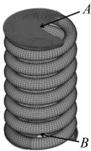
图 1 圆柱形螺旋弹簧有限元模型
