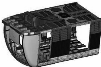
图 1 截取的地铁车辆车体子模型
