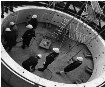
图 2 整环管片衬砌足尺试验
