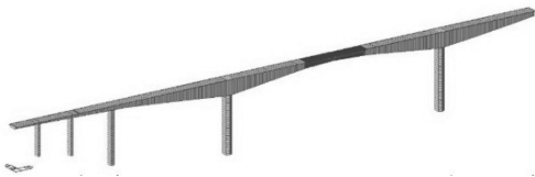
图 1 嘉华轨道桥有限元模型示意图
