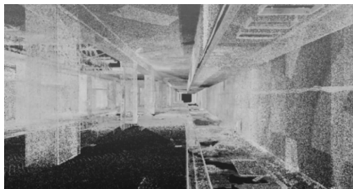
图5 拼接后站台层点云模型
