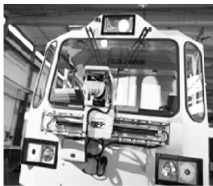
图1 轨检车安装激光雷达 图2 车载激光雷达的识别
