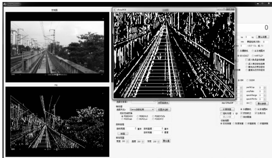
图 9 真实线路的障碍物识别测试
