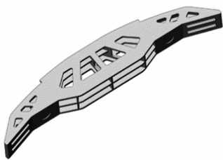
图 5 防爬齿精细化设计
