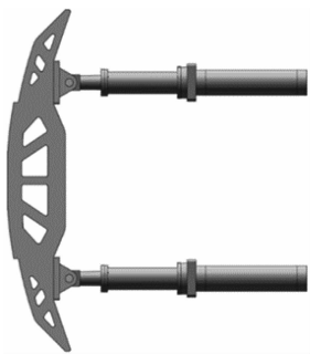
图 6 轻型防爬器结构
