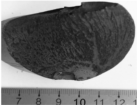
图 5 弹簧断口宏观形貌
