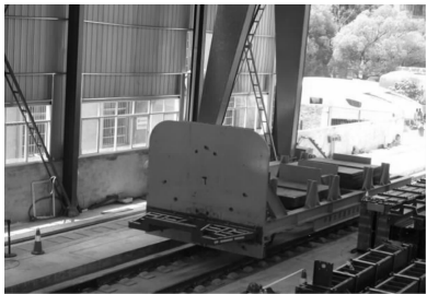
图 14 碰撞台车和试验样件
