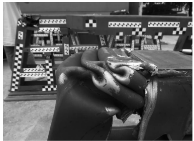
图 15 碰撞试验后的样件变形情况
