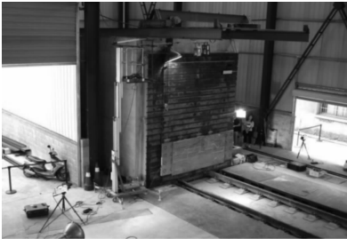
图 13 碰撞试验用刚性碰撞墙
