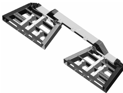
图9 吸能结构变形情况
