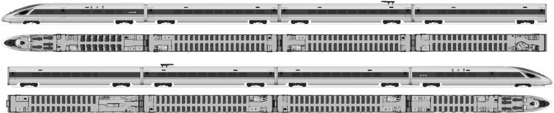
图 1 复兴号智能型动车组总体布置
