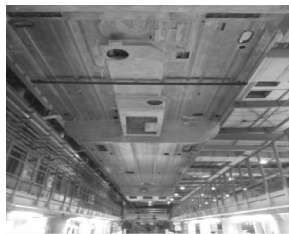
图8 车体底架落入工装
