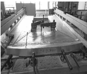
图7 端墙外部端梁组焊
