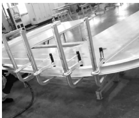
图6 端墙中部弯梁组焊
