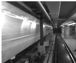
图11 侧墙与底架拉紧
