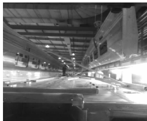
图10 侧墙落入底架
