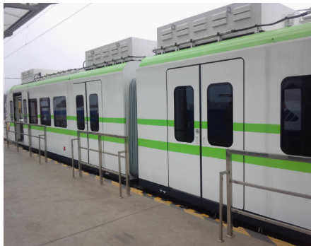
图5 储能车车体全包贴膜
