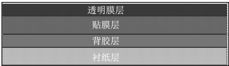
图 1 PVC 贴膜的主要结构示意图
