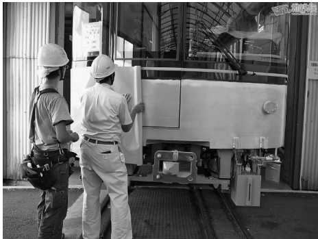
图3 正在贴膜的车体
