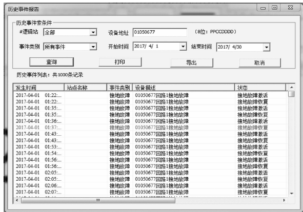
图 3 FAS 系统存在故障报警时的监视界面
