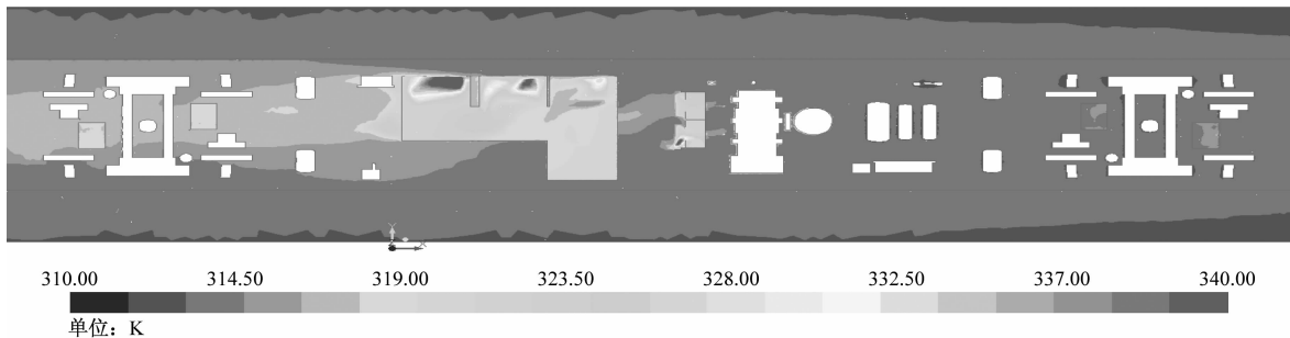
图4 截面列车设备舱温度分布云图
