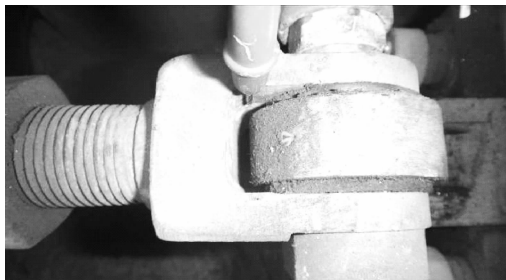
图 5 正常转辙机空气间隙
