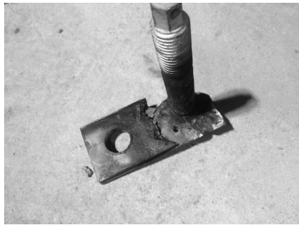
图 7 烧损的绝缘垫
