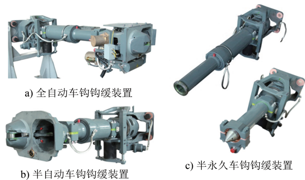
图 1 常规轨道交通车辆钩缓配置示意图
