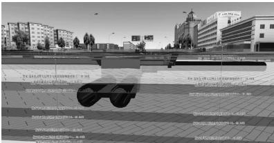
图3 地下土层自动建模与地下水分布分析效果
