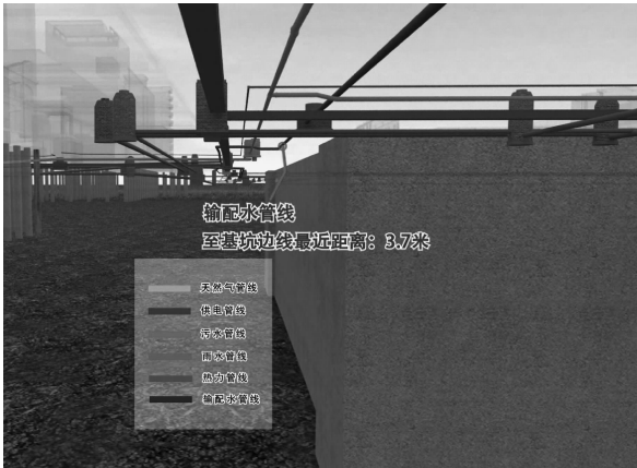
图2 地下管网自动构建及管线切改成果图
