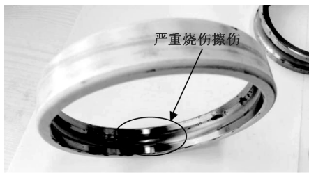
图7 电机轴承1损伤图
