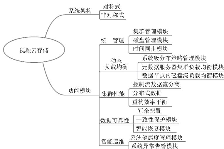
图 1 视频云存储系统的架构及功能模块示意图
