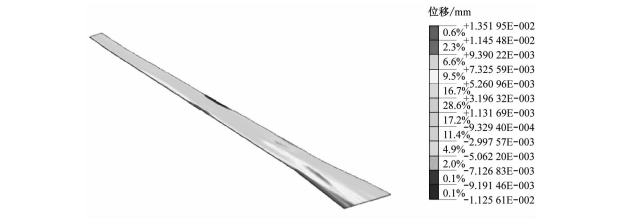
图 5 工况二水平位移云图 Fig. 5 Nephogram of horizontal displacement under condition II
