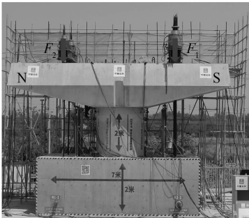
图 3 足尺模型的加载试验现场 Fig. 3 Site of full-scale model loading test
