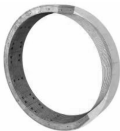
图 6 单管片环激光扫描示意图
