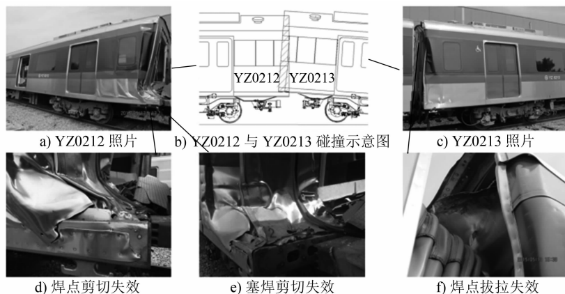
图8 YZ0212车体与YZ0213车体撞击后的变形照片
