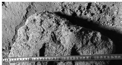
图 12 注浆后砂体黏结效果
