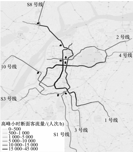
图 10 南京轨道交通工作日高峰小时最大客流量断面位置 Fig. 10 Peak hour maximum passenger flow section positions of Nanjing rail transit on weekdays
