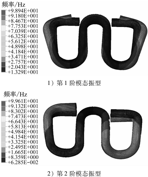
图 2 WJ-2 型弹条在自由状态下的前两阶模态振型
