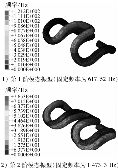
图9 内腔填充铁素体球墨铸铁的弹条在安装状态下的模态振型
