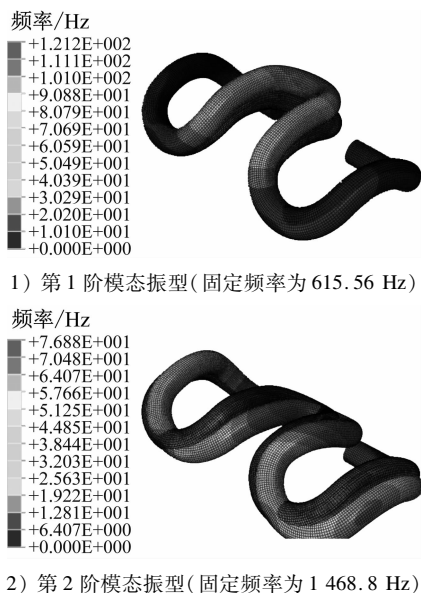
图8 内腔填充灰口铸铁的弹条在安装状态下的模态振型
