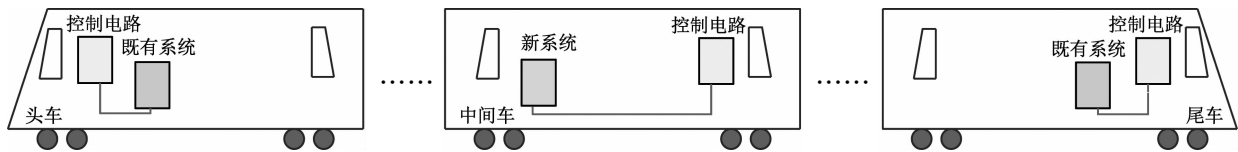
图 2 车载信号系统集中式安装示意图
