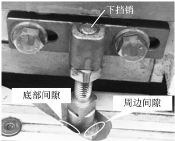
图 1 塞拉门下挡销示意图
