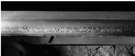
图 3 既有 P60 型钢轨下道时的轨面状态
