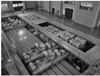
图 6 机车车辆滚动振动试验台
