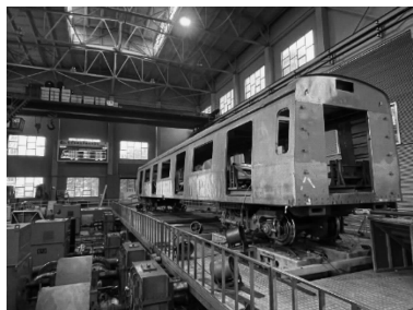
图7 滚振试验实景图
