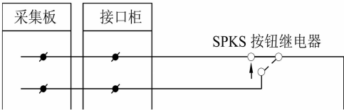
图 1 SPKS 采集电路 Fig. 1 SPKS collection circuit
