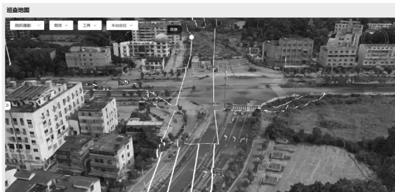
图6 地铁保护区范围在城市三维实景模型中的叠加展示
