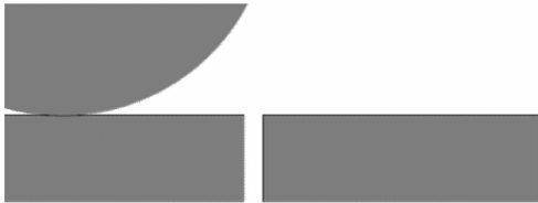
图 2 轨道断裂故障仿真模型图
